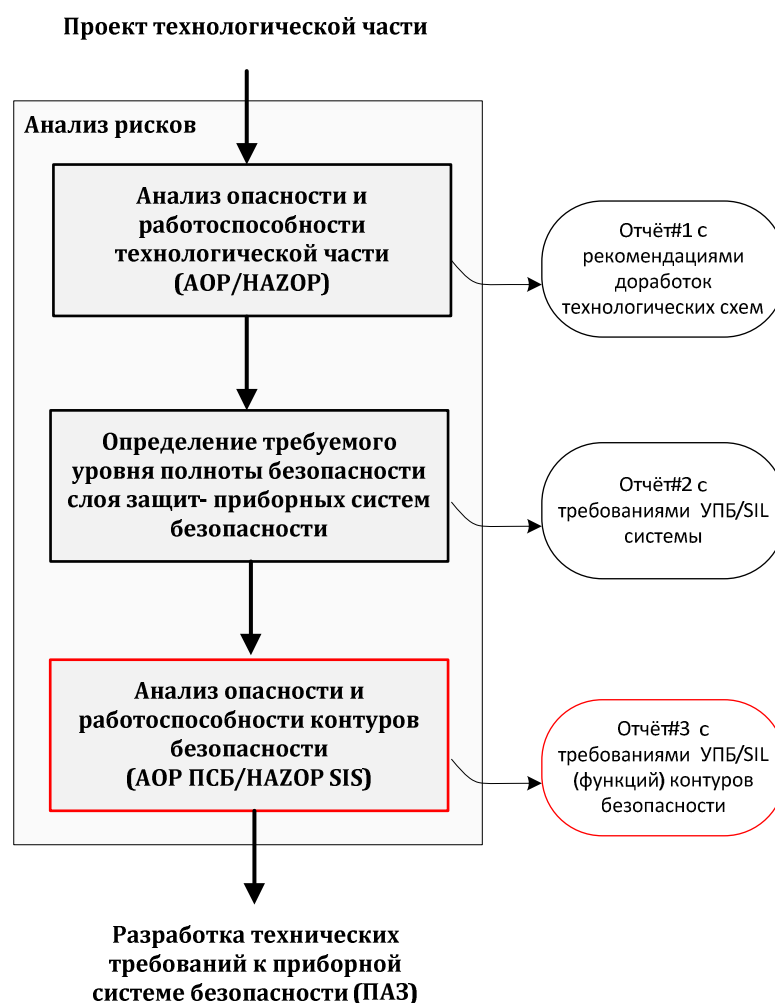
Рис.1 Этапность проведения анализа рисков. Проведение HAZOP SIS.
